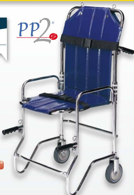
**CHAISE PORTOIR PLIABLE PP2** équipée de 2 roues, d'un repose-pieds, de 2 sangles de retenue et de 4 poignées repliables. Conforme à la Norme NF EN 1865. Testée à 250kg de charges en essais statiques et en dynamiques par le CNMIS. Dimensions pliée : 50,5 x 49 x 17 cm. Poids 9 kg.
